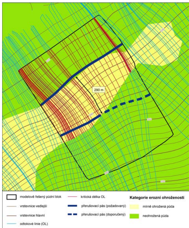
Obr. 2-16: Přerušovací pásy na PB/DPB se skloností do 3° (přerušované zobrazeno doporučené opatření)
