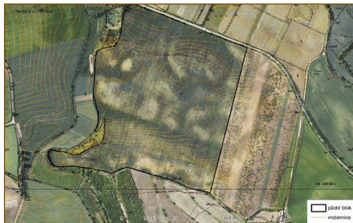
Obr. 3-10: Ortofotosnímek půdního bloku, který poukazuje na poškození půdy vodní erozí (vybělená místa)
