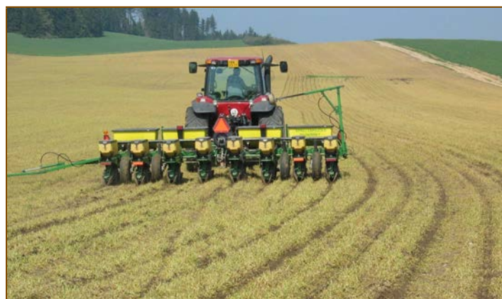
Obr. 4-10: Kukuřice setá bezorebným secím strojem do mulče žita setého (Sedmihorky, foto: ZEA Sedmihorky)
