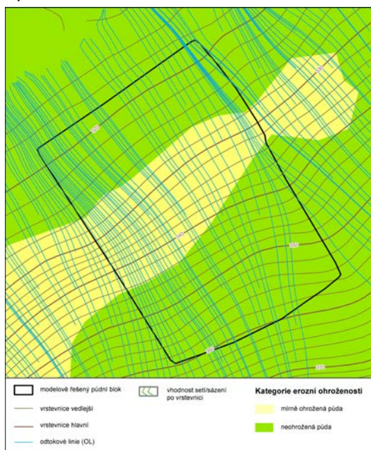
Obr. 2-36: Setísázení po vrstevnici
