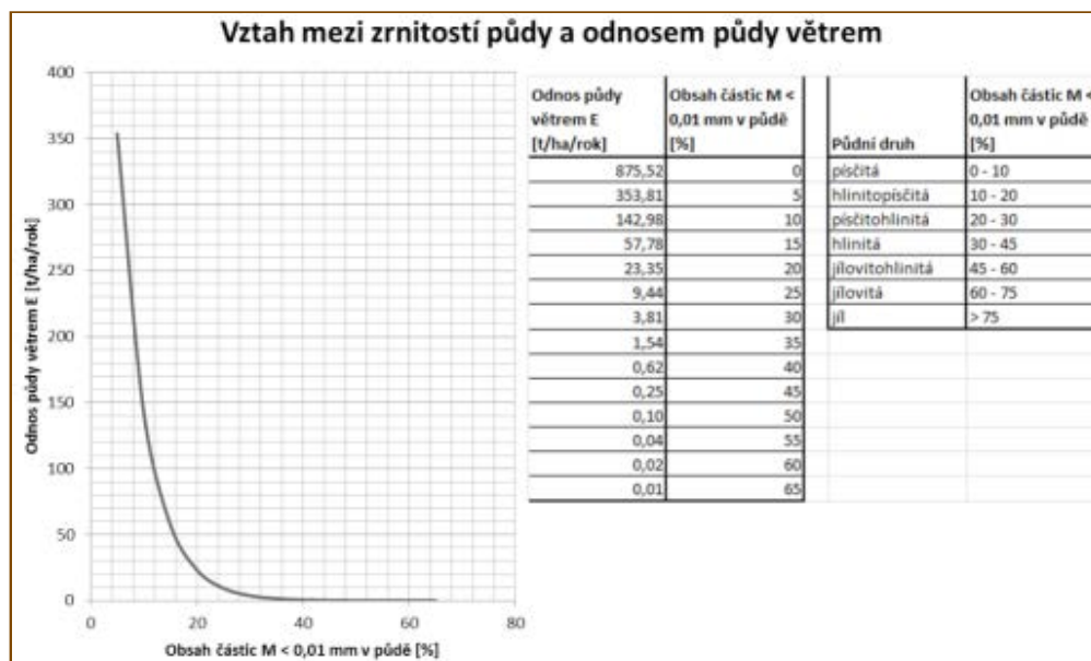
Obr. 6-9: Nomogram pro odhad erodovatelnosti půdy větrem podle Pasáka a kol. (1984)
